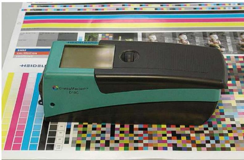
Equipo que brinda un valor numérico correspondiente al grado de oscurecimiento de la película revelada y, de acuerdo con esa lectura, determinar si se encuentra o no dentro del rango técnicamente aceptado.
