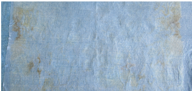
Foto 1. Lavado por contacto utilizando SONTARA ® . Puede apreciarse el absorbente saturado de la suciedad extraída del documento.
