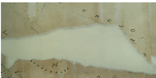
Fotos 13 y 14. Elaboración y aplicación de injertos sobre áreas faltantes Plano Hacienda San Miguel
