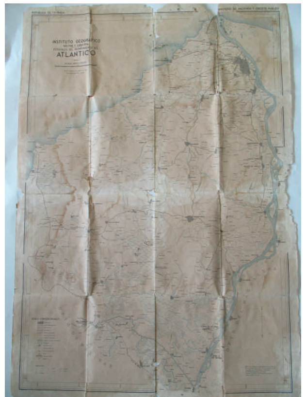
Imagen 4. Deformación de plano por inadecuado almacenamiento. Fuente: propia
