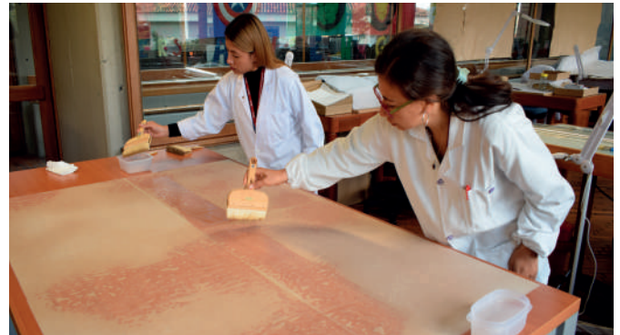
Foto 10. Doblaje, devolución de plano y secado sobre tablero de madera Plano del Ferrocarril del Pacifico 1.929 (80 cm x 54 cm)
