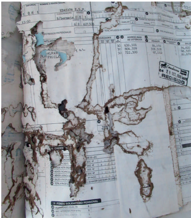
Imagen 12. Galerías y excrementos por ataque de termitas (comején). Fuente: propia
