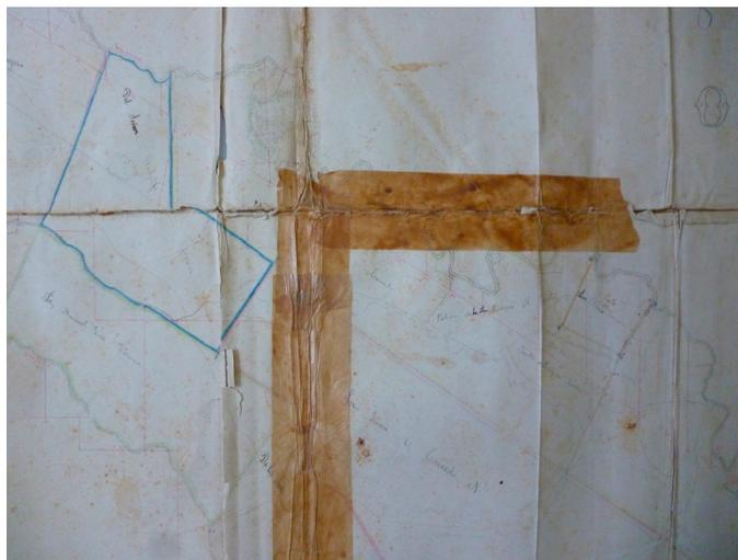
Foto 3. Cinta transparente utilizada sobre un plano para solucionar rasgaduras generadas por dobleces, el adhesivo está completamente oxidado generando manchas oscuras que comprometen el soporte y la información, deterioro que es totalmente irreversible.
