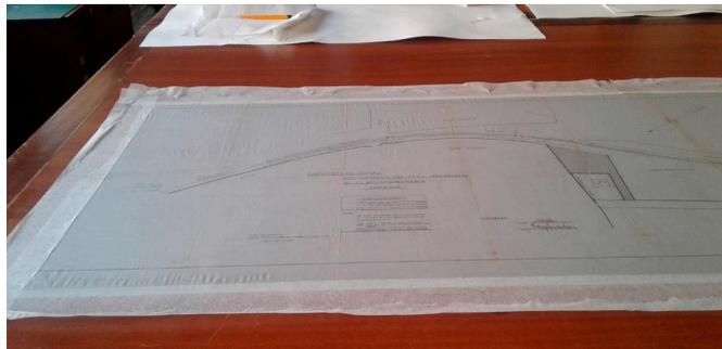
Foto 10. Corrección de plano mediante tiras de refuerzo adheridas a una superficie de madera.
