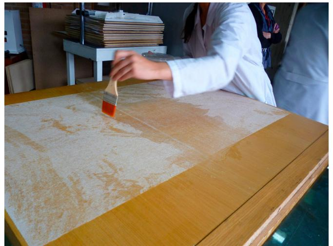
Foto 14. Alistamiento del papel de doblaje sobre el tablero de madera.
