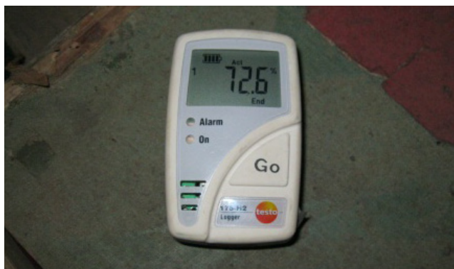
Registrador de datos de temperatura y humedad relativa – DATALOGGER
