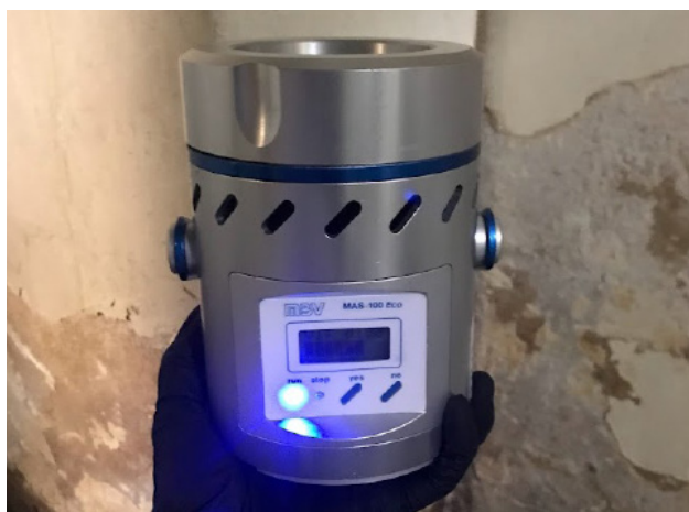
Figura 9. Dispositivo de monitoreo de microbiota ambiental por Impactación. Fuente: Archivo fotográfico Laboratorio de Ciencias. Grupo de Conservación BNC (2019)
